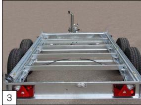
Serienausstattung: Verschweißtes oder im Vollbad verzinktes Fahrgestell für Tandemachser.
