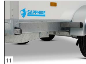
Serienausstattung: Kotflügelträger zur Befestigung von Kotflügeln montiert.
