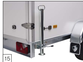
Option: Schiebstützen montiert.
