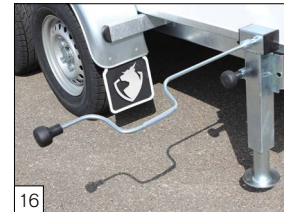
Option: solide Kurbelstützen (drehbar und einstellbar) einschließlich Kurbel.
