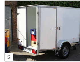
Option: Einachsige Kühlwagen bis 1800 kg ZGG, Maße bis maximal 300 x 150 x 210 cm.
