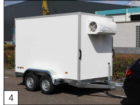
Option: Doppelachsige Kühlwagen bis 3500 kg ZGG, Maße bis maximal 400 x 180 x 210 cm.
