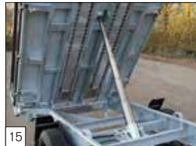
Serienausstattung: verstärktes Chassis mit solidem 5-Stufen-Hydraulikzylinder montiert.
