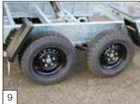
Serienausstattung: Bereifung 185/70 R13 C mit schwarzen Felgen.
