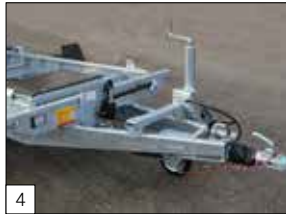
Serienausstattung: mit Nothandpumpe bei Elektropumpe ausgestattet.
