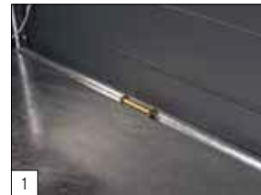
Serienausstattung: in den Seitenrahmen integrierte Verzurrbügel mit einer Kapazität von 1000 daN.
