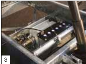
Serienausstattung: elektrische Bedienung inkl. Batterie in Stahlkasten mit Kunststoffdeckel.
