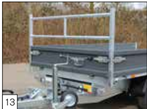
Serienausstattung: Verstärktes Gitter vorne, herausnehmbar, Vorderwand klappbar.
