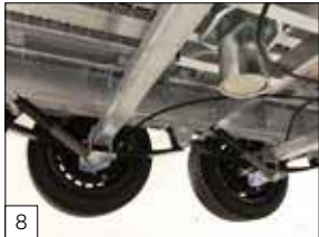
Serienausstattung: Parabelfederung inkl. Stoßdämpfern an den Achsen.
