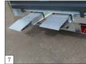
Serienausstattung: verstärkte Aluminium-Auffahrschienen, 2500 mm lang, integriert unter den Boden.
