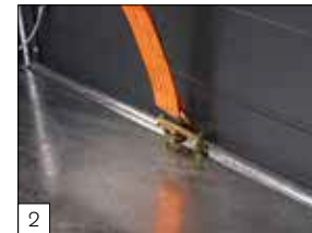
Serienausstattung: die Verzurrbügel sind TÜV-zertifiziert.
