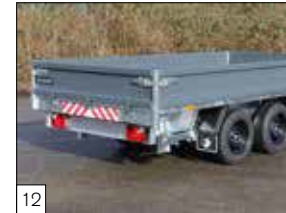
Serienausstattung: Stahlwände, 350 mm hoch (mit KTL-Behandlung und Pulverbeschichtung) und Abschirmung der Heckleuchte montiert.
