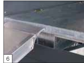
Serienausstattung: an der Heckseite ein U-Profil zum Anlegen der Auffahrschienen.
