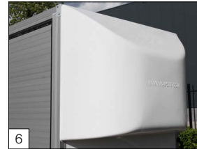
Option: Spoiler (Polyester) an der Vorderseite angebracht.
