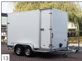
Option: Seitentür mit Scharnieren und Verschlüssen aus Edelstahl.
