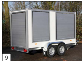
Option: Aluminium-Aufroll-Rolläden auf der Rückseite und Schiebeläden an den Seiten.
