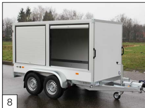
Option: 2 Aluminium-Schiebeläden (maximal 150 cm breit) in der Seitenwand inkl. Mittelpfosten.
