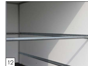
Option: Ladungssicherungssystem in dem geschlossenen Aufbau mit Sperrstange und Spanngurt.
