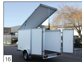
Option: aufklappbarer Deckel an der Vorderseite (möglich bis zu einer Größe von max. 300 x 150 x 180 cm).
