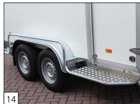
Option: Seitliche Schutzbügel mit Aluminium-Trittplatte.
