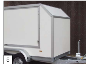
Option: abgeschrägte Front (gleicher Winkel von etwa 40 x 40 cm).
