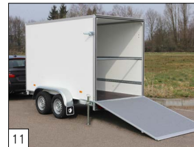
Option: Heckklappe mit grauer Anti-Rutsch-Beschichtung versehen.
