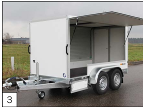
Option: Seitenklappe und vor dem Kotflügel eine Klappe, die sich nach unten aufklappen lässt.
