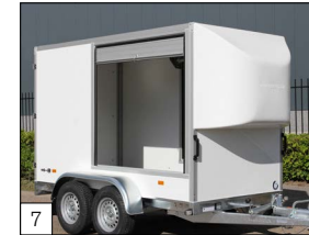
Option: Aluminium-Schiebelade in der Seitenwand.
