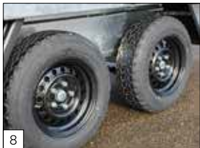
Option: schwere Profil-Bereifung 185/70 R13 C inkl. schwarzer Felgen statt Reifen 195/50 R13.
