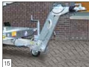
Option: höhenverstellbare Zugdeichsel, montiert, mit Kugelkupplung oder Öse.
