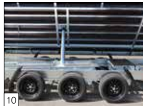
Serienausstattung: die 2- und 3 achsigen Ausführungen sind serienmäßig ausgestattet mit Parabelfederung inkl. Stoßdämpfer und Bereifung 195/50 R13 inkl. schwarzer Felgen.
