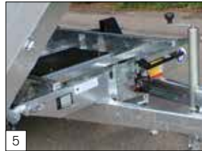
Option: Nothandpumpe bei Elektropumpe, montiert.
