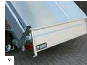
Option: Heckbordwand oben und unten pendelnd (nur möglich in Kombination mit Bordwände 40cm).
