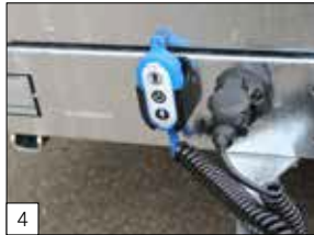
Serienausstattung: abnehmbarer Bedienungs-Kasten inkl. verlängertem Spiral-Kabel.
